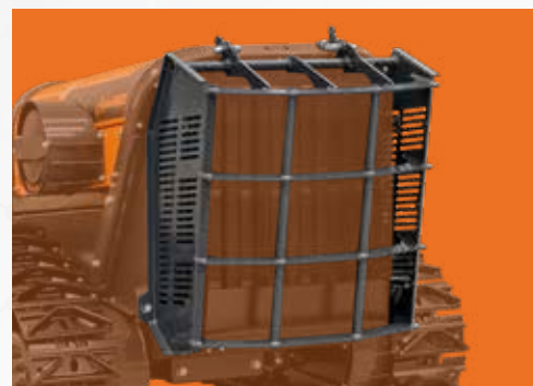
Protección del radiador de acero Proteção do radiador em aço
