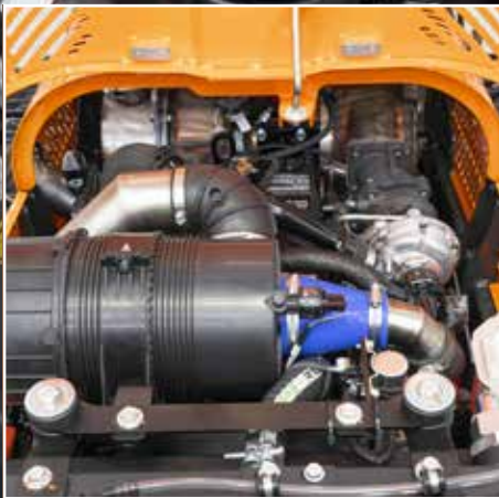
MOTOR YANMAR DE 60 CV FASE V MOTOR YANMAR DE 60 CV STAGE V
