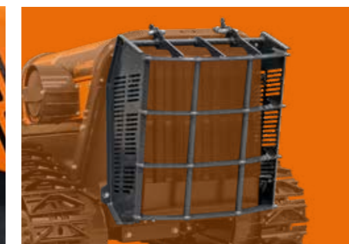
Protezione radiatore in acciaio Steel radiator protection
