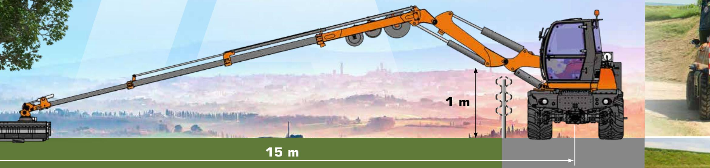
**BRACCIO TELESCOPICO DA 15 METRI CON TESTATA TRINCIANTE**
