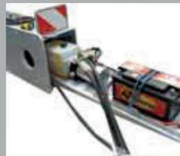
Bomba eléctrica 12V y set de baterías 70Ah
