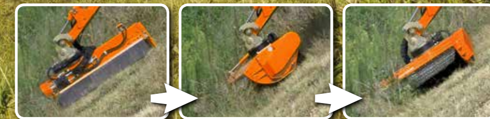
Rotazione cabina e rotazione testata trinciante Cabin and cutting head rotation
